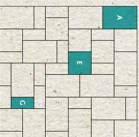
Cathedral Paving Pac è stato realizzato utilizzando tre differenti lastre (A, E e G).
